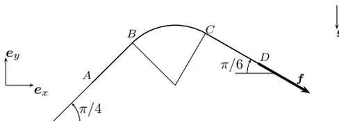
sollecitato da una forza  $\mathbf{f}$  di intensità  $4pR$  tangente al segmento  $CD$  e la lunghezza del tratto  $CD$  è  $2R$ . In condizioni di equilibrio determinare: il valore della tensione nel punto  $C$ ; il valore della tensione nel punto di  $AD$  di quota massima; il valore minimo di  $\mu$  perché il filo sia in equilibrio.
