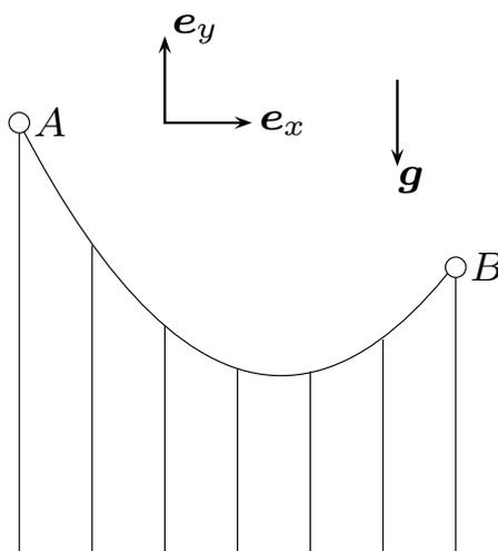
il punto più basso del cavo si trova a dislivello  $2\ell$  sotto  $A$ , trovare il rapporto  $\rho$  tra il massimo ed il minimo valore della tensione nel cavo.
