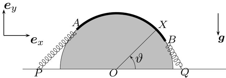
attratti verso punti  $P$  e  $Q$  dell'orizzontale per  $O$  da molle ideali di costanti elastiche  $2\sqrt{3}p/R$  e  $\gamma p/R$ , rispettivamente. Se  $OP = R\sqrt{2}$  e  $OQ = 2R/\sqrt{3}$ , trovare il valore di  $\gamma$  compatibile con l'equilibrio nella configurazione descritta in figura.
