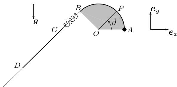
un punto materiale di peso  $2p$  ed i due fili sono collegati in  $B$  e  $C$  con una molla ideale di costante  $p/R$ . In condizioni di equilibrio determinare: il valore della tensione nel punto più alto di  $AB$ ; la lunghezza di  $CD$  e l'elongazione della molla.
