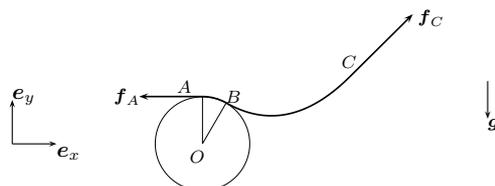
di intensità  $\sqrt{2}\gamma mg$ , inclinata di  $\pi/4$  sull'orizzontale. Sapendo che in  $A$  agisce una forza  $\mathbf{f}_A = -14mg\mathbf{e}_x$ , determinare, in condizioni di equilibrio, la tensione del filo nel punto  $A$ ; il valore di  $\gamma$  compatibile con l'equilibrio e, in corrispondenza, il dislivello  $\Delta y = y_C - y_B$ .
