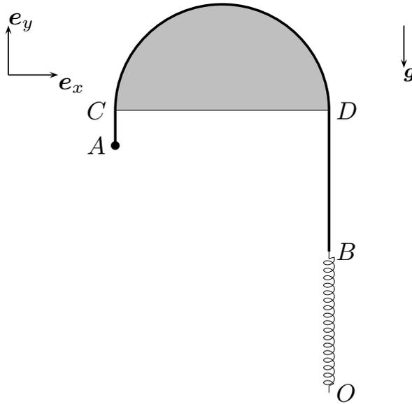
da una molla ideale di costante elastica  $mg/R$  verso un punto fisso  $O$  posto a distanza  $4R$  da  $CD$ , sulla stessa verticale di  $B$ . In condizioni di equilibrio, determinare la lunghezza di  $AC$ , l'elongazione della molla e la tensione nel punto medio dell'arco  $CD$ .
