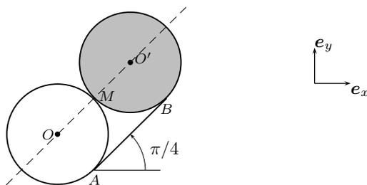
base  $\{\mathbf{e}_x, \mathbf{e}_y\}$  (**2 punti**); la matrice di inerzia del corpo rispetto al punto  $M$  precisando, per ogni elemento di matrice, i contributi dei singoli corpi (**8 punti**). Determinare gli autovalori di questa matrice ed individuare l'inclinazione della base principale di inerzia rispetto alla base  $\{\mathbf{e}_x, \mathbf{e}_y\}$  (**4 punti**).
