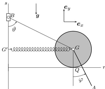
La velocità angolare del disco  $\omega e_z$  si ricava osservando che, da una parte, essendo  $G - G' = 4\ell \sin \vartheta e_x$ , si ha
