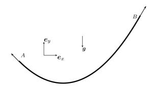
Se centriamo l'origine di un sistema di assi cartesiani ortogonali centrato nel vertice della catenaria, con assi paralleli ad  $\{e_x, e_y\}$ , l'equazione della catenatia si esprime come
