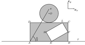
di lati  $EF = 2\ell$  ed  $FL = \frac{2\ell}{\sqrt{3}}$ , con i vertici  $E, F, L$  sui lati del primo rettangolo e  $DF = \ell$ . Tangente al punto medio di  $DC$  è un disco di raggio  $\ell$  e massa  $3m$ . Determinare per il rettangolo forato e per il disco di centro il momento di inerzia rispetto alla retta  $s$  inclinata di  $\frac{\pi}{3}$  sull'orizzontale, passante per il punto  $A$  (**10 punti**).
