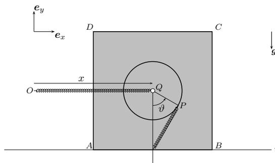
indicate in figura, determinare l'energia cinetica (**2** punti) e l'energia potenziale del sistema (**2** punti). Qualificare i modi normali di oscillazione in un intorno della configurazione di equilibrio stabile (**7** punti).
