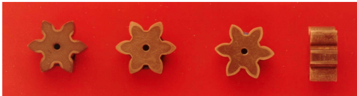
MF: nur der Zahnfuß wird erwärmt
