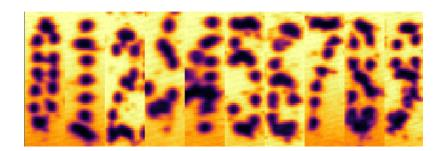
Un sistema di visione automatico deve eseguire delle analisi sui numeri stampati. Un passaggio fondamentale del processo di automazione industriale è di classificare correttamente le singole cifre stampate sui succhi di frutta nel minor tempo possibile.
